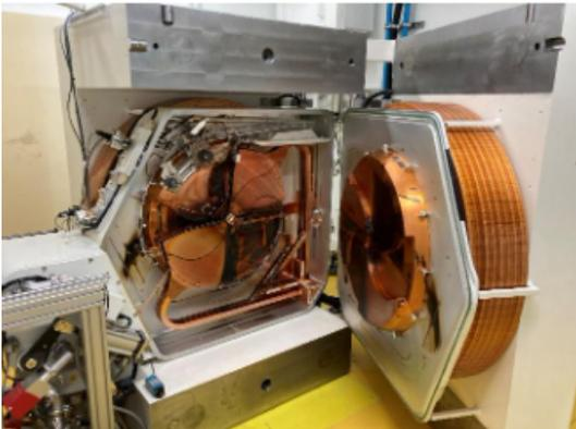
*Un ciclotrón es una máquina aceleradora de partículas que utiliza campos electromagnéticos y señales de RF para impulsar partículas cargadas a velocidades y energías muy altas, que se utilizan para producir radioisótopos, como el 18F, que son componentes esenciales / centrales de los radiofármacos.*
